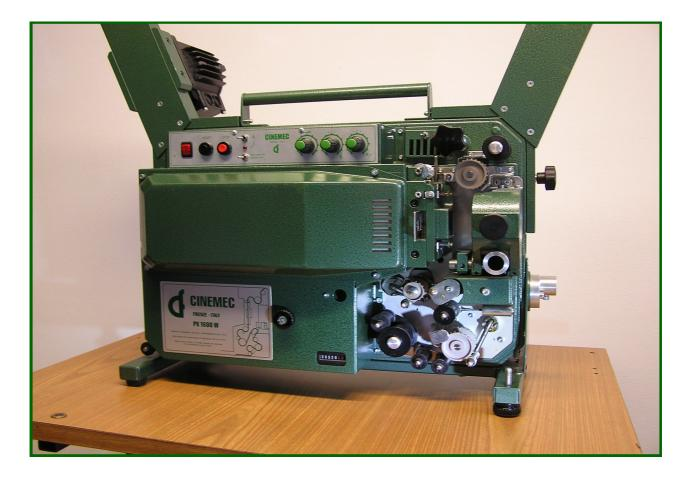
dimensioni - dimensions - dimensions: mm. 495x270x420H peso - weight - poids : Kg. 29 in assetto di trasporto
